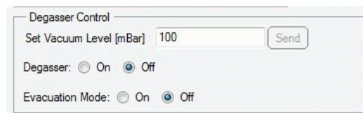
Рисунок 1 Панель управления встроенным дегазатором программы Agilent Lab Advisor.
