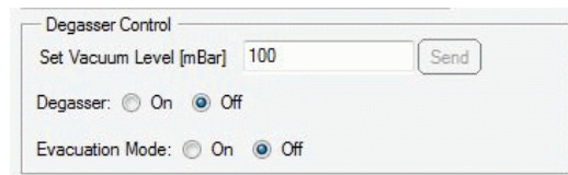
Figura 2 Control de los desgasificadores internos en Agilent Lab Advisor
