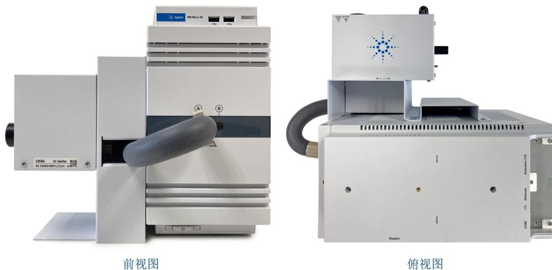
图 6. 连接到 990 Micro GC 的传输线
