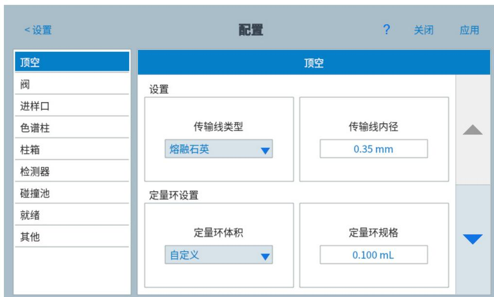
图 14. 显示在 GC 本地用户界面中的顶空方法参数 (8890 GC)
