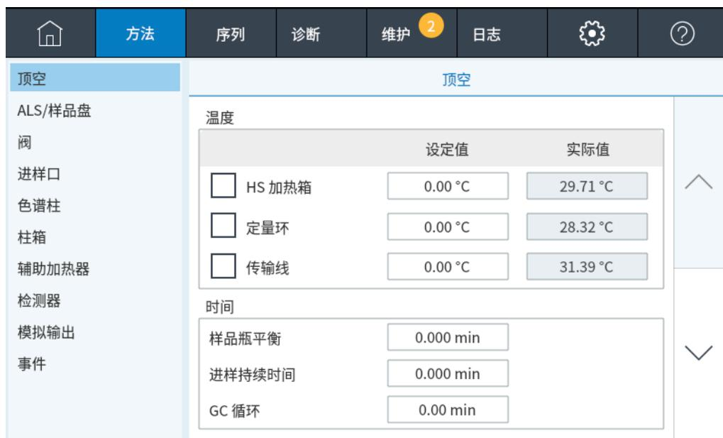
图 13. 显示在 GC 本地用户界面中的顶空方法参数
