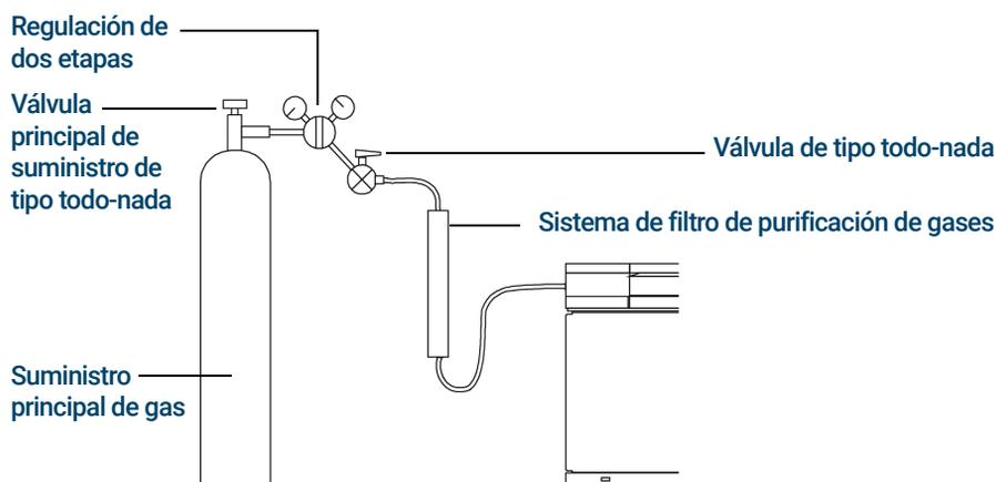
La configuración del filtro de purificación de gases variará en función de la aplicación.
