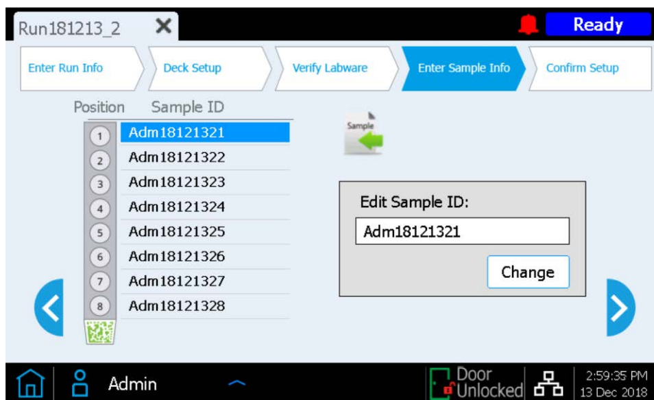
图 4 用于在运行期间手动分配样本的 Magnis 触摸屏界面。
