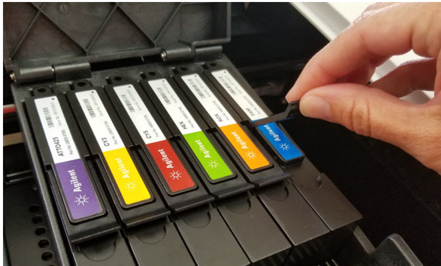
Figure 52 Soulever la languette à charnière d'un module optique
