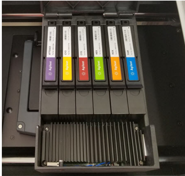
Figure 10 Modules optiques installés
