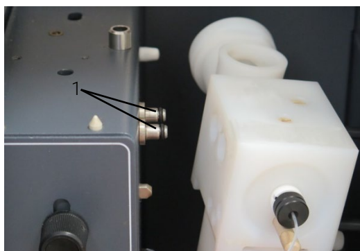
Figura 5. Cámara de nebulización retirada de la entrada de gas, donde:
