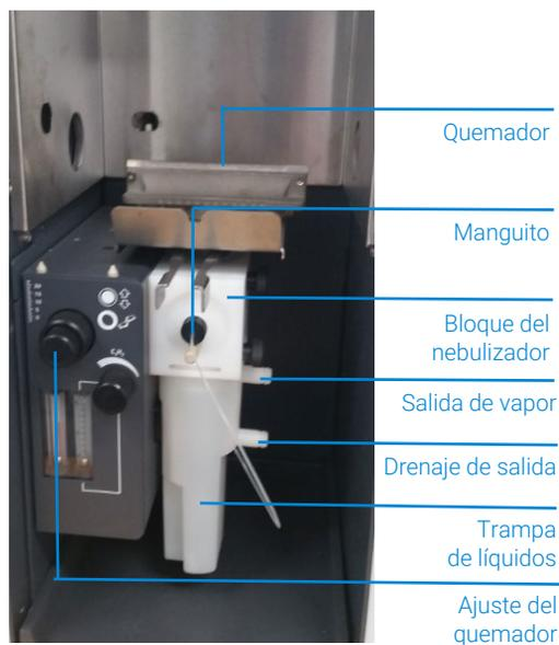
**Figura 7.** Compartimento de la muestra del que se han retirado el panel frontal y el protector de llama
