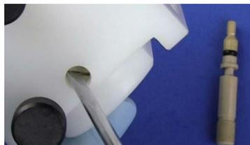
**Figura 57.** Afloje el tornillo de sujeción; en el lateral del nebulizador.
