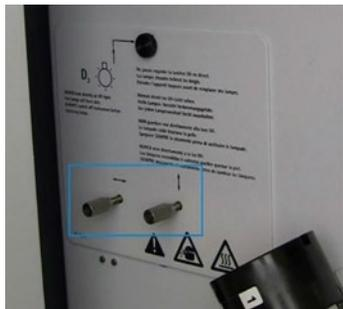
**Figura 30.** Manillas de ajuste de la lámpara de D<sub>2</sub>
