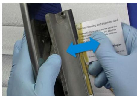
**Figura 82.** Deslice la tarjeta de limpieza del quemador hacia dentro y hacia fuera de la ranura
