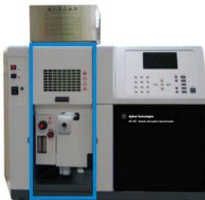
Figura 6. Compartimento de la muestra
