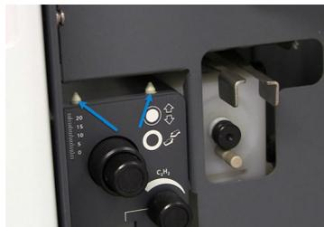
**Figura 12.** Baje el panel frontal del compartimento de la muestra sobre las dos orejetas situadas en la parte superior del regulador del quemador.
