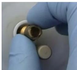
**Figura 50.** Introduzca la guía para cojinete de abrazadera en el bloque del nebulizador.
