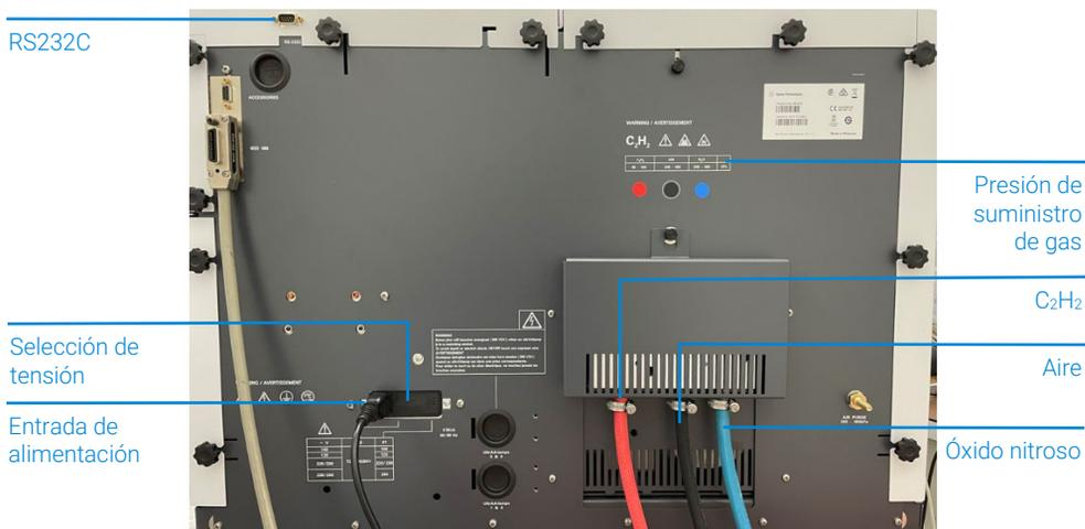
Figura 4. Espectrómetro de absorción atómica de llama Agilent 55B AA; vista posterior
