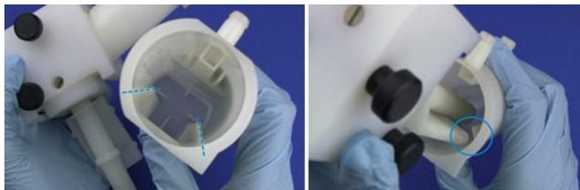
**Figura 71.** Baje el tubo de drenaje y el flotador hacia la trampa
