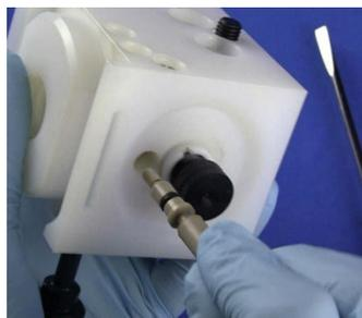
**Figura 56.** Retire el tornillo de ajuste de la bola de impacto; en la parte frontal del nebulizador
