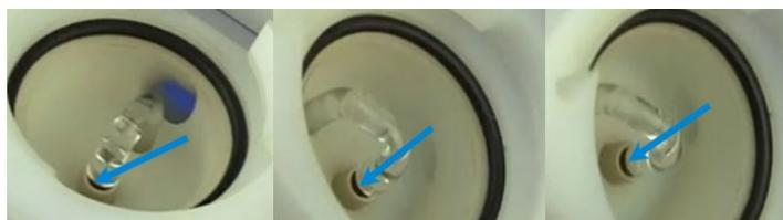
**Figura 66.** Separación uniforme de aproximadamente 0.5 mm entre la bola de impacto y la garganta del venturi
