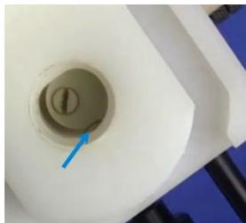
**Figura 63.** Tornillo de sujeción tocando el bloque de ajuste de la bola de impacto
