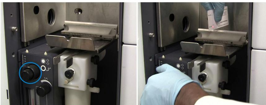
**Figura 34.** Manillas de ajuste del quemador (izquierda).
