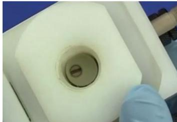
**Figura 67.** Bloque de ajuste de la bola de impacto centrado
