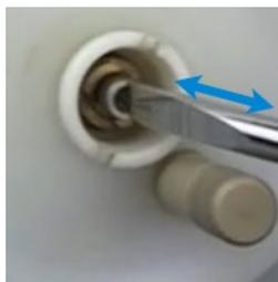
**Figura 51.** Compruebe el funcionamiento del resorte
