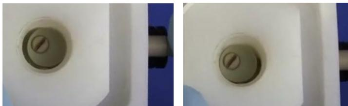
**Figura 64.** Rango de movimiento del bloque de ajuste de la bola de impacto
