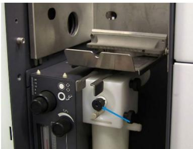
**Figura 37.** Ubicación del manguito. El anillo de bloqueo se encuentra entre el manguito y el bloque del nebulizador
