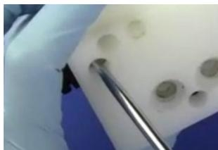
**Figura 61.** Apriete el tornillo de retención; en el lado de entrada de gas del nebulizador
