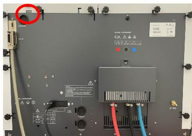
**Figura 40.** Conector RS-232 de 9 clavijas ubicado en la parte posterior del instrumento
