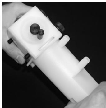
Figura 72. Bloquee la trampa en su posición
