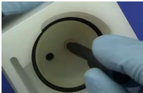
**Figura 43.** Inserte la herramienta de extracción en el venturi
