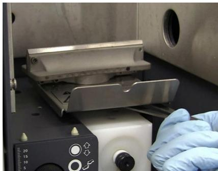
**Figura 31.** Apriete las puntas del asa de rotación para girar el quemador
