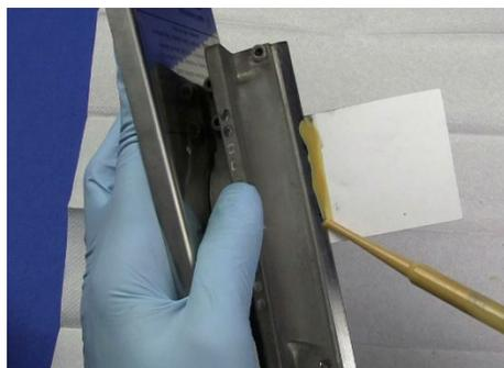
**Figura 81.** Aplique limpiador de metales en la tarjeta de limpieza del quemador
