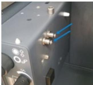
**Figura 74.** Boquillas de salida de combustible y oxidante
