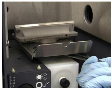
**Figura 79.** Apriete el asa de rotación para girar el quemador
