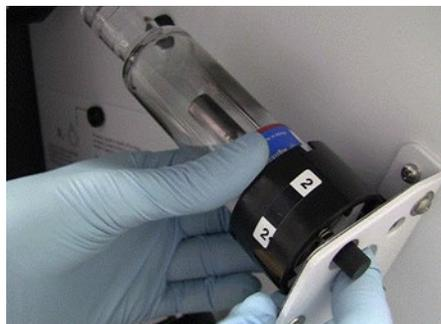
Figura 86. Montura de la lámpara de cátodo hueco
