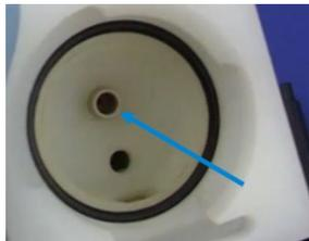
**Figura 46.** Extensión del venturi a la parte posterior del bloque del nebulizador
