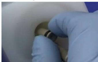
**Figura 44.** Introduzca el venturi en el bloque del nebulizador
