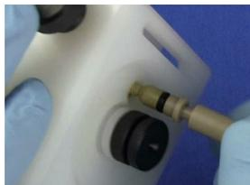
**Figura 60.** Introduzca el tornillo de ajuste de la bola de impacto
