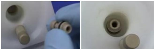
**Figura 45.** Introduzca la guía de capilares en el bloque del nebulizador
