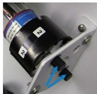
**Figura 28.** Manillas de ajuste de la lámpara
