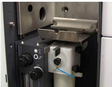
Figura 36. Tornillo de ajuste de la bola de impacto
