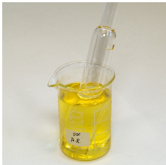
图 15D. 浸泡在王水中的石英外管组
