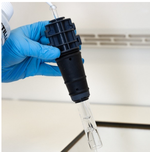
图 16A. 通过球形接头用去离子水冲洗中心管
