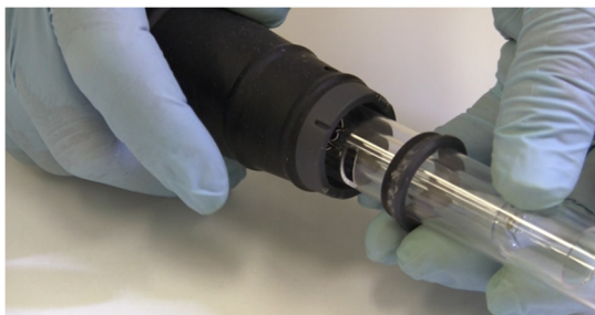
图 6. 炬管插入炬管体中
