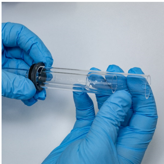
图 4. 顶部密封垫重新安装到石英外管组上
