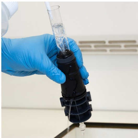
图 16B. 用去离子水冲洗气孔和球形接头
