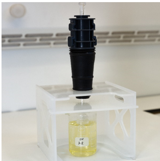
图 15A. 将炬管浸入王水溶液中。确保中心管浸入溶液中
