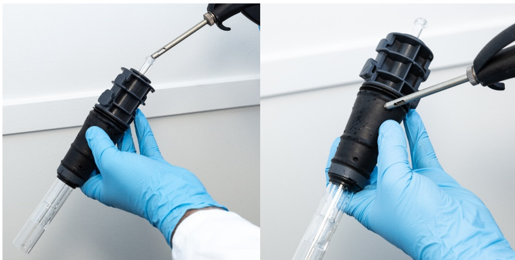
图 18A 和 B. 使用压缩空气、氩气或氮气干燥炬管
