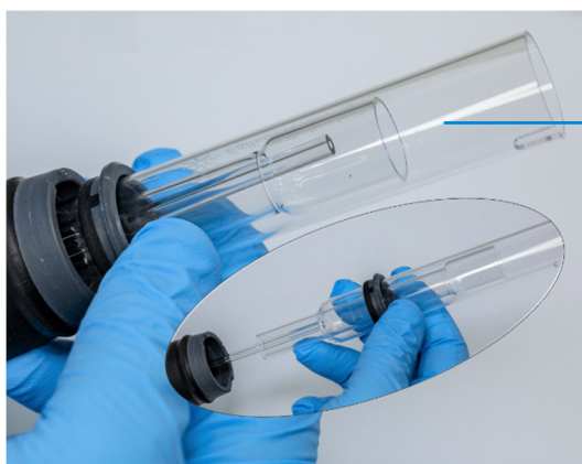
图 11. 从炬管体上卸下石英管组
