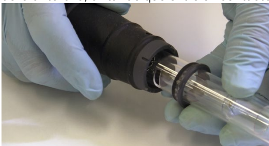
Figura 6. Antorcha insertada en el cuerpo de la antorcha.
