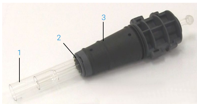
Figura 3. Antorcha desmontable: 1. Antorcha; 2. Sello superior; 3. Cuerpo de la antorcha.
