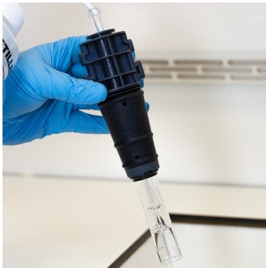
Figura 16A. Lavado del inyector con agua desionizada a través del conector de rótula.
