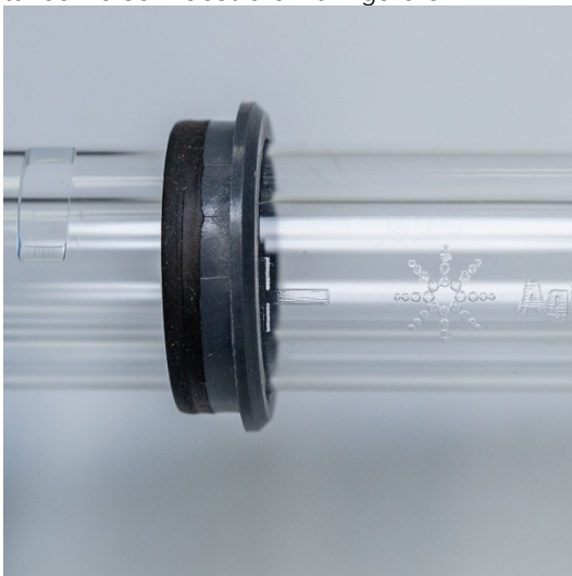
Figura 5. Alineación del sello superior con la marca de alineación del tubo exterior de cuarzo.
