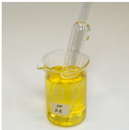
Figura 15D. Conjunto del tubo exterior de cuarzo remojado en agua regia.
