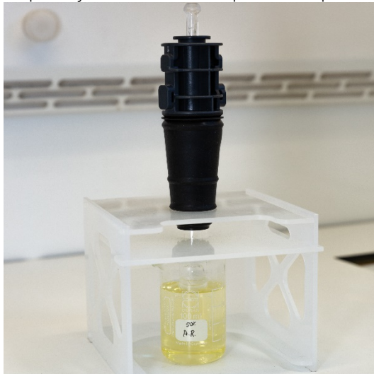
Figura 15A. Remojo de la antorcha en la solución de agua regia. Asegúrese de que el inyector esté sumergido en la solución.
