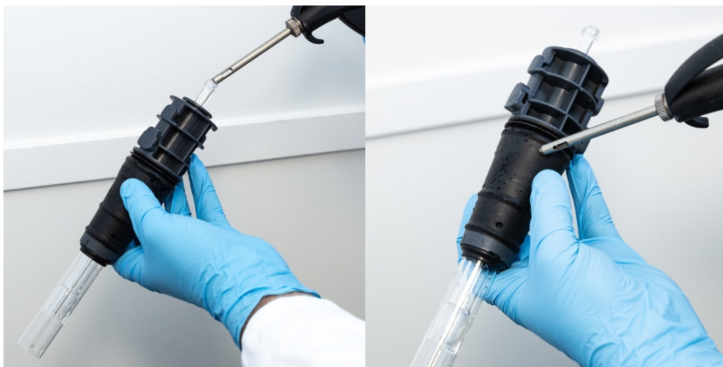
Figura 18A y B. Uso de aire comprimido, argón o nitrógeno para secar la antorcha.
