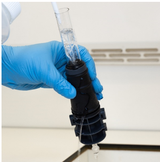
Figura 16B. Lavado de los puertos de gas y el conector de r tula con agua desionizada.
