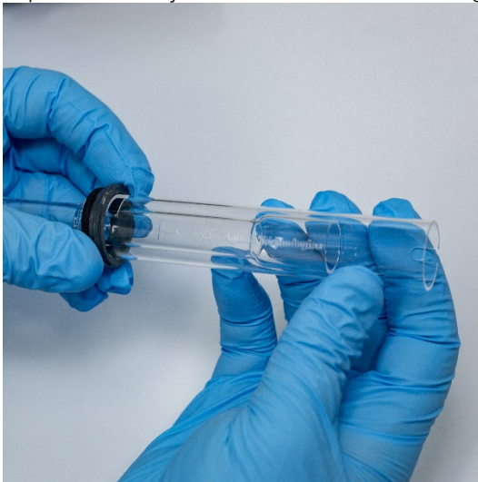
Figura 4. Montaje del sello superior en el conjunto del tubo exterior de cuarzo.
