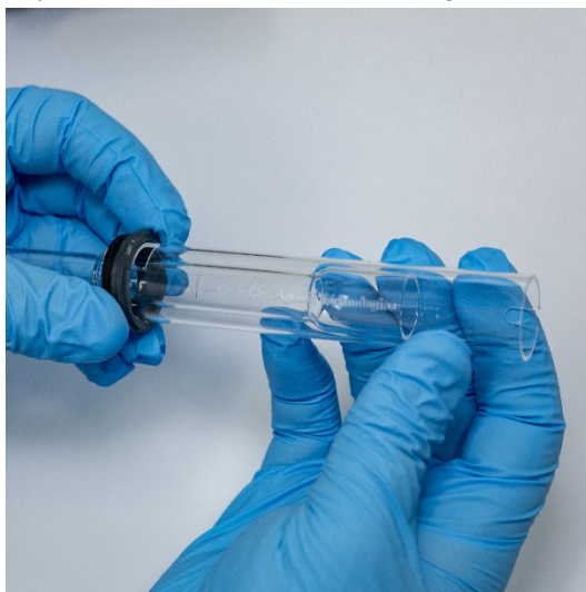
Figura 4. Rimontaggio della guarnizione superiore sul set di tubi esterni in quarzo
