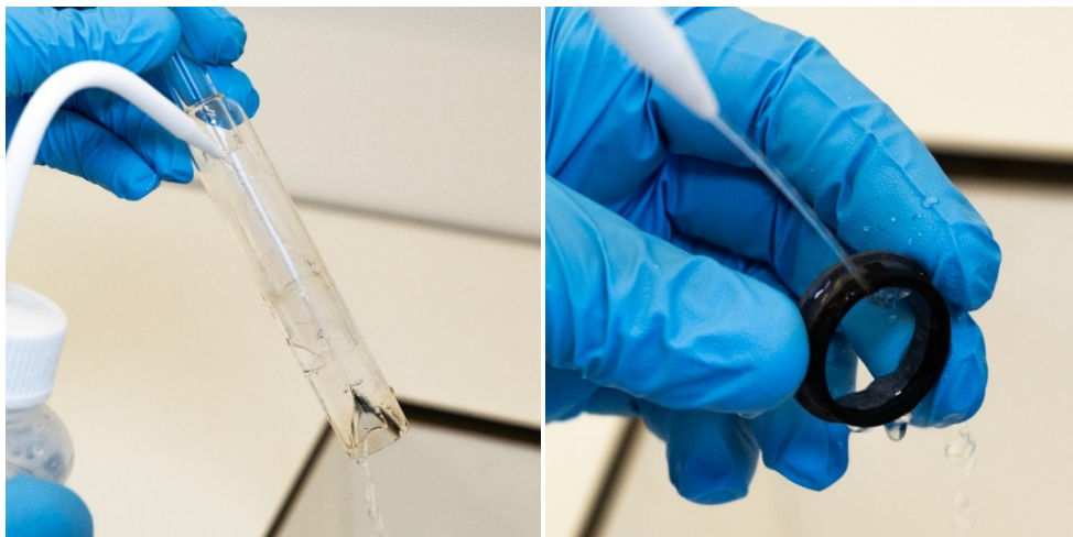
Figura 17A e B. Risciacquare con acqua deionizzata il set di tubi esterni in quarzo e la guarnizione superiore.
