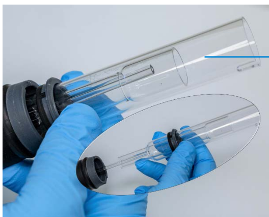
Figura 11. Rimozione del set di tubi in quarzo dal corpo della torcia
