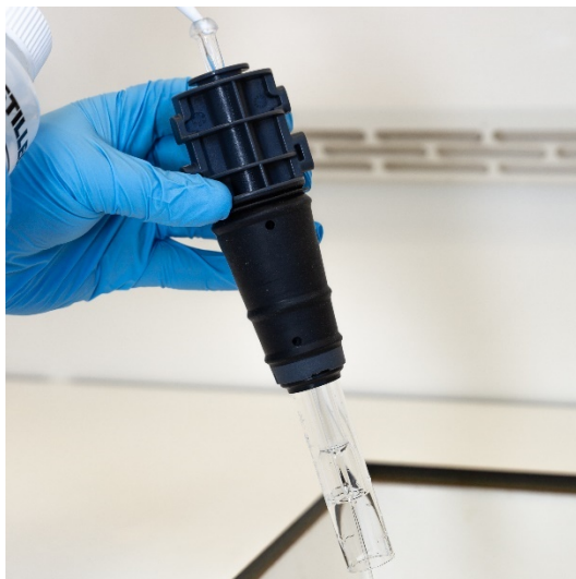
Figura 16A. Risciacquare l'iniettore con acqua deionizzata attraverso il connettore del giunto sferico.
