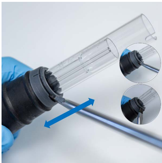
Figura 10. Rimozione della guarnizione superiore con l'aiuto di un cacciavite a testa piatta larga
