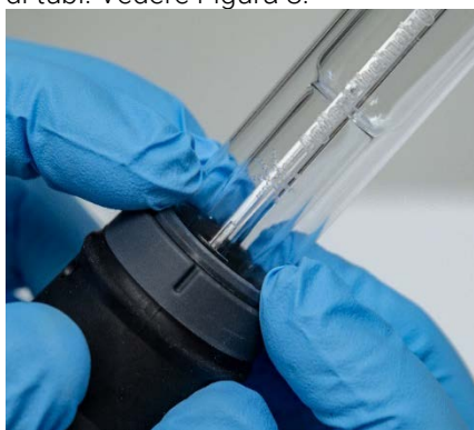
Figura 8. Assicurarsi che la guarnizione sia alloggiata correttamente esercitando pressione sui bordi superiori
