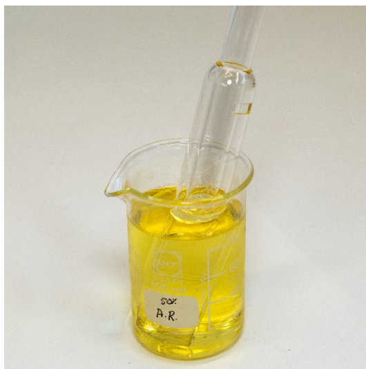
Figura 15D. Set di tubi esterni in quarzo immerso in acqua regia.
