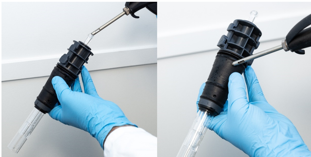
Figura 18A e B. Usare aria compressa, argon o azoto per asciugare la torcia.
