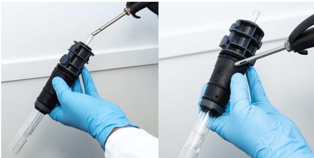
Abbildung 18A und B. Trocknen der Fackel mit Druckluft, Argon oder Stickstoff.
