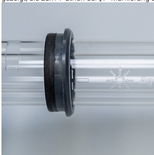
Abbildung 5. Die obere Dichtung ist bis zur Markierung auf das Quarzaußenrohr geschoben
