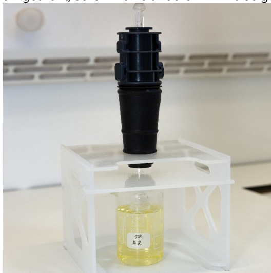
Abbildung 15A. Reinigen der Fackel in der Königswasserlösung. Stellen Sie sicher, dass der Injektor ganz in die Lösung eintaucht.
