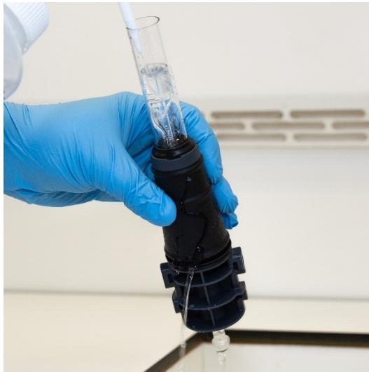
Abbildung 16B. Spülen der Gaseinlässe und der Kugelgelenkverbindung mit deionisiertem Wasser.
