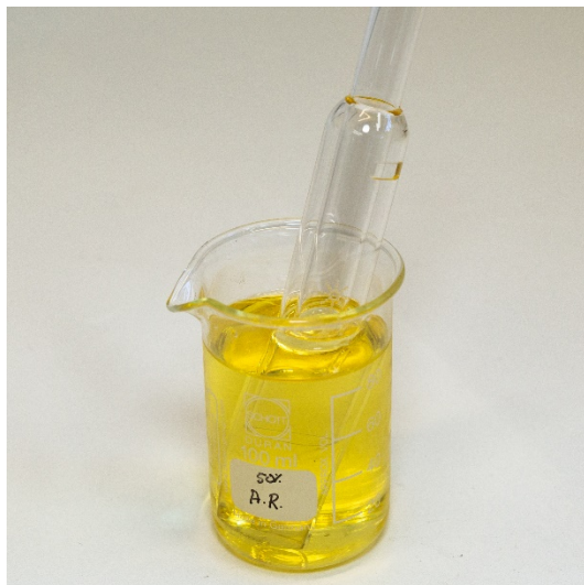
Abbildung 15D. Quarz-Außenrohrset taucht in Königswasser ein.
