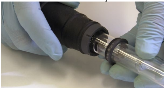
Abbildung 6. Fackel wird in den Fackelkörper eingesetzt
