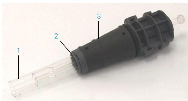
Abbildung 3. Zerlegbare Fackel mit: 1. Fackel, 2. Obere Dichtung und 3. Fackelkörper
