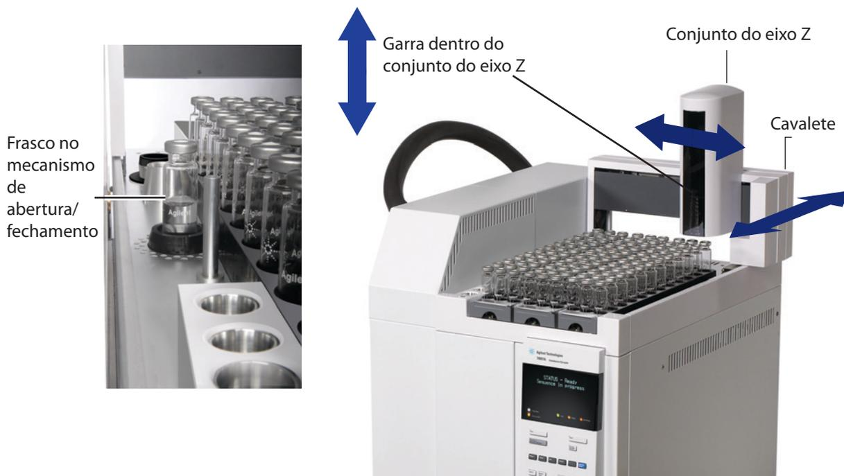
Figure 12 Partes móveis da bandeja
