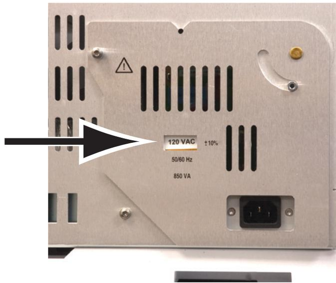
Se a configuração de alimentação não combinar com a voltagem disponível, entre em contato com a Agilent. Você precisará ter o cabo e o plugue de alimentação corretos para a voltagem. Consulte o manual de [Instalação](#) e o guia de [Preparação do local](#), para mais informações.
