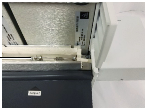
图 17 安装后面板和微型气化器，然后使用 1/16 英寸 Swagelok 接头将微型气化器样品管线连接到内部进样口。
