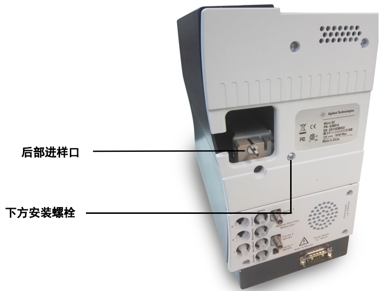
图 21 后部进样口和下方安装螺栓
