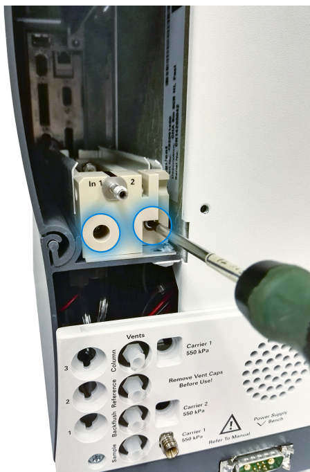
图 16 拧下两颗螺栓，取下 PEEK 模块。
