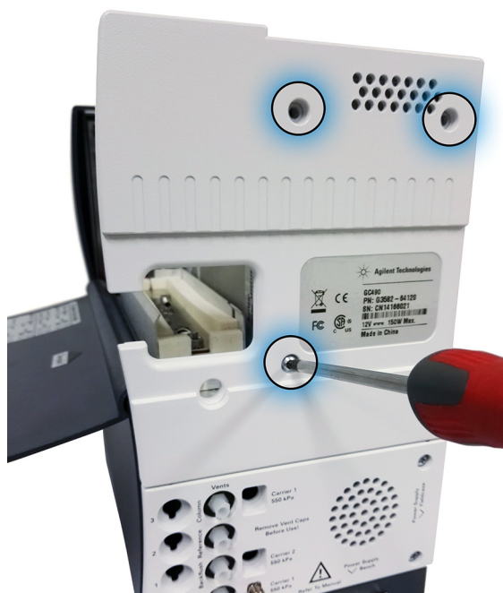
图 15 拧下三颗螺栓，取下后面板。
