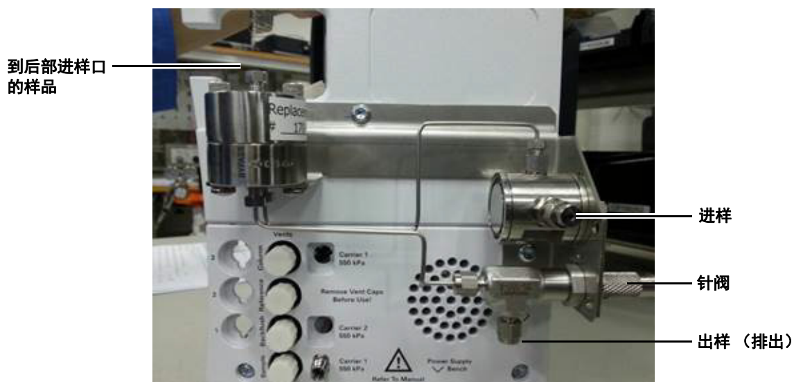
图 22 已安装 G3581-S0003 压力调节器配件
