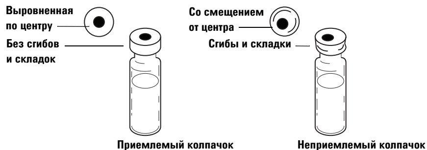
Рис. 54 Приемлемые и неприемлемые колпачки виал
