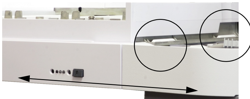
Рис. 5 Правильная установка лотка для проб.
