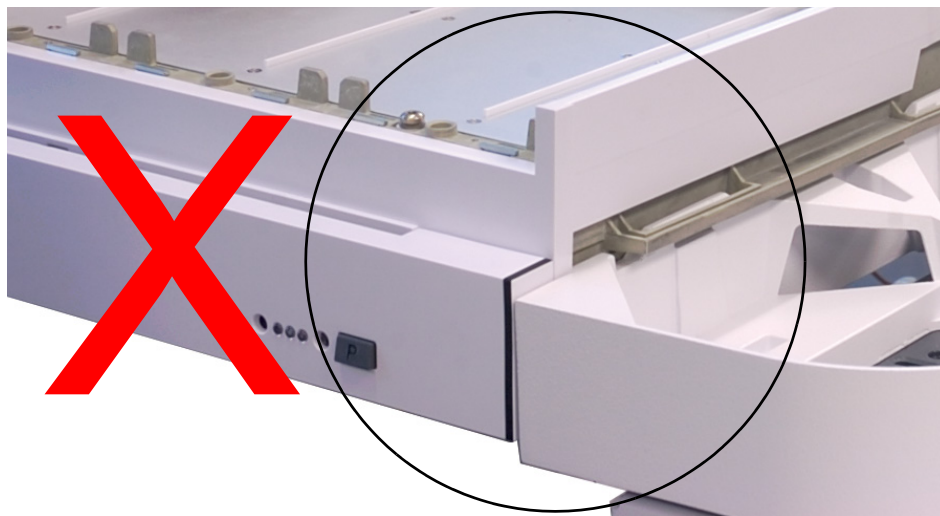
Рис. 6 Неправильная установка лотка для проб.
