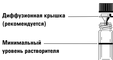
Рис. 55 Емкость для растворителя или отходов вместимостью 4 мл
