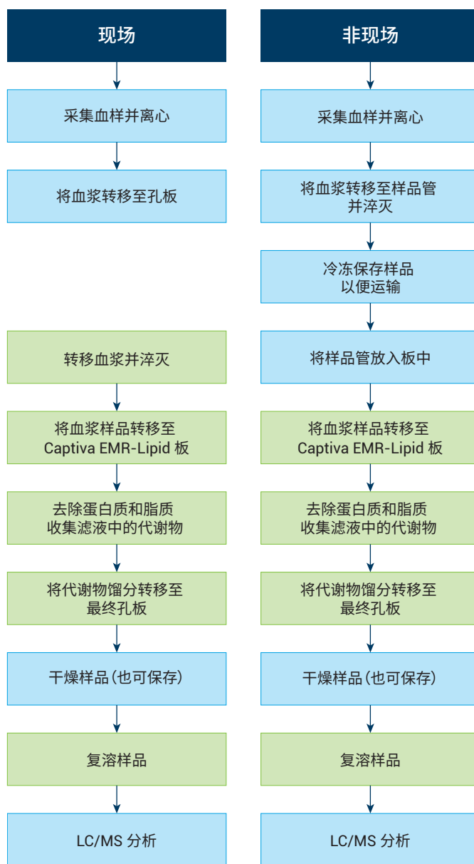
图 1. 从血浆中提取代谢物的自动化工作流程。绿色步骤由 Agilent Bravo 平台完成
