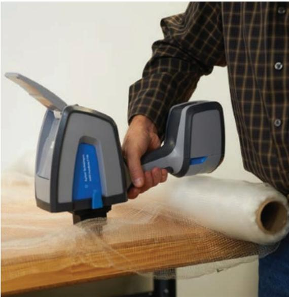
그림 1. Agilent 4300 Portable FTIR을 이용하여 중합체를 쉽게 식별할 수 있습니다
