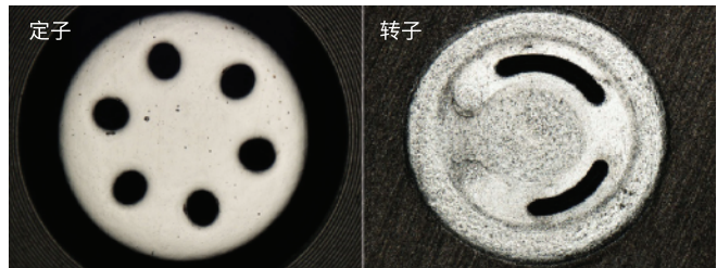
图 10. 安捷伦转子密封垫经过 30000 次切换循环后，定子和转子的表面仍然干净平整
