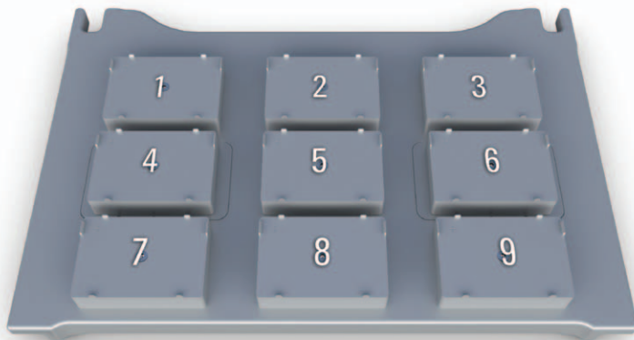
图 3. Bravo 自动化液体处理平台 9 个台板可用于放置配件和实验室器皿
