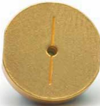
Le nouveau joint d'injecteur en or Agilent, ayant fait l'objet d'une demande de brevet, améliore la durée de vie des colonnes en éliminant les traces des rainures d'usinage qui peuvent provoquer de petites fuites.
