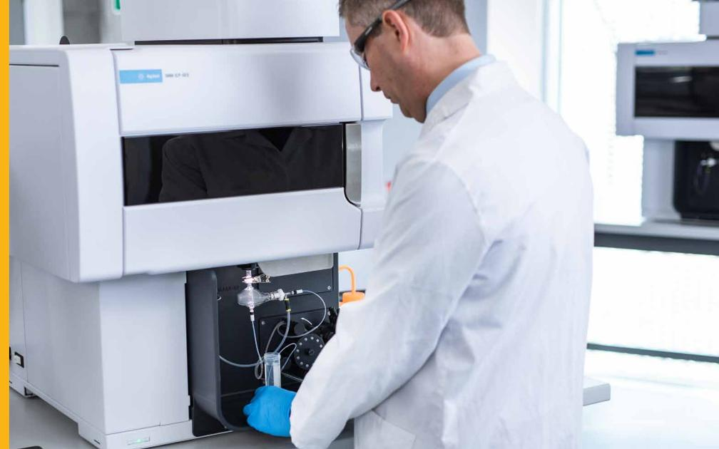
電池材料のサプライチェーン全体でのサンプルの元素分析は、ICP ベースの分析技法では困難です。ここでのサンプルは通常、全溶解固形分 (TDS) 含有量が高く、イオン化しやすい元素を含んでいます。例えば、 $\text{LiCO}_3$  を分析する場合、プラズマ内にリチウムイオンが多量に存在すると、ナトリウムやカリウムなどのイオン化しやすい元素の測定に影響を与え、誤った結果が得られるおそれがあります。電池材料サンプルはまた、高いバックグラウンド信号を示し、干渉があるのが一般的です。リチウムはまた、トーチをはじめとするサンプル導入系を劣化させることで有名です。
