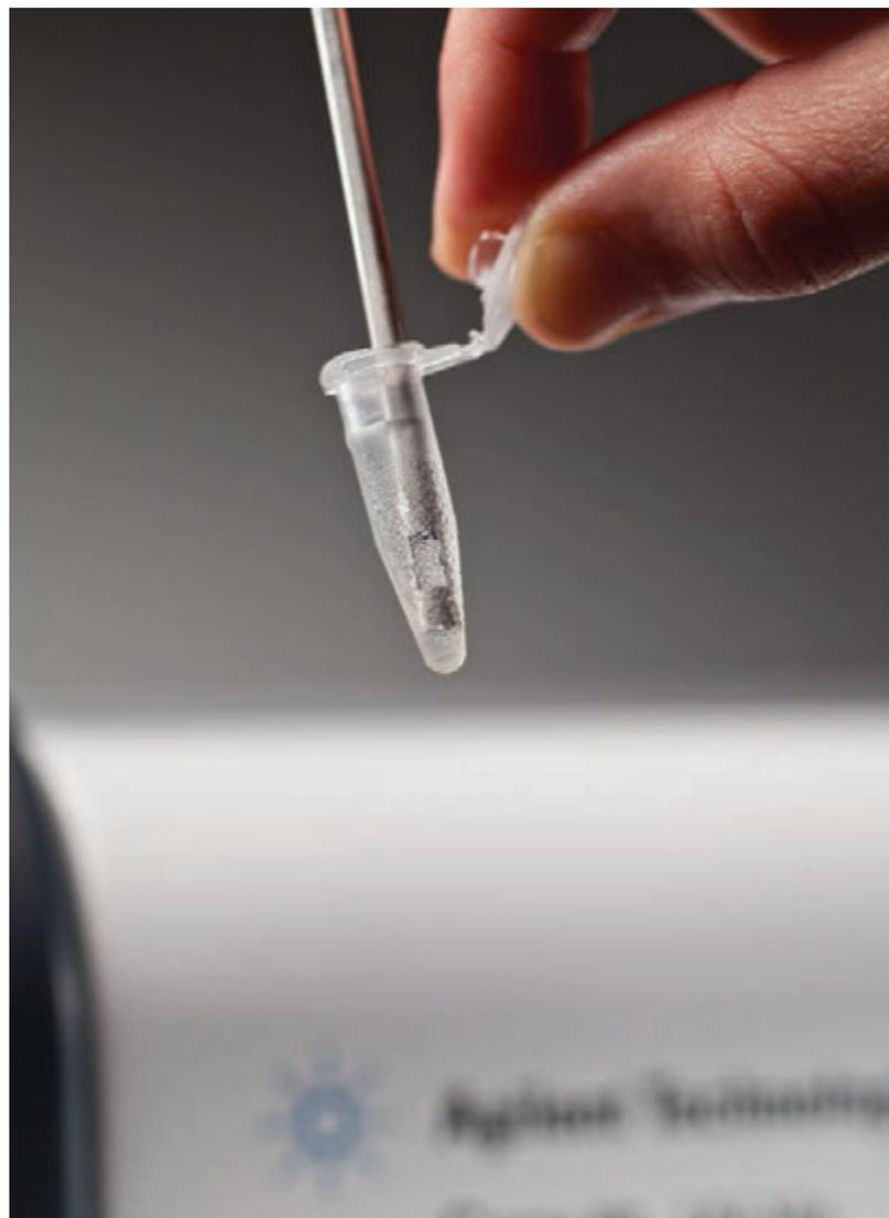
Figure 6. Un accessoire du type sonde à fibre optique peut être installé sur un spectrophotomètre UV-Vis pour réaliser des mesures sur des échantillons liquides contenus dans diverses sortes de récipient.
