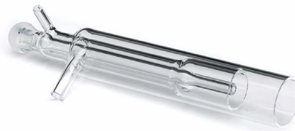
等离子体由石英管中流动的氩气形成。
