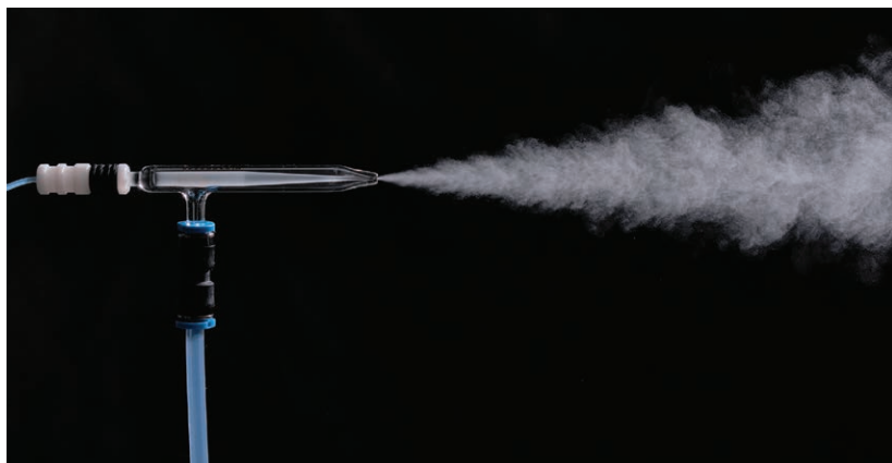
雾化器将液体样品雾化为气溶胶。
