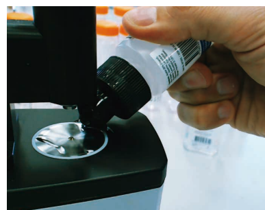
図 3. Cary 630 FTIR に取り付けられた ATR アクセサリー上に、希釈していない消毒剤のサンプルをセットします。Agilent MicroLab ソフトウェアには画像によるワークフローが用いられているため、洗浄やサンプリングなど、測定の各ステップに従って実行できるようになっています。
