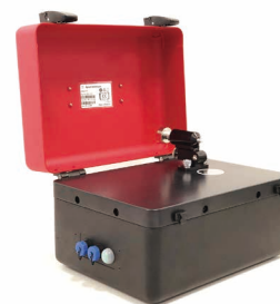
図 2. バッテリー式の堅牢なポータブルアナライザ Agilent 4500 FTIR は、現場での分析に最適です。
