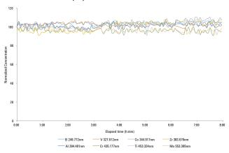
**오래 지속되는 안정성:** 모든 원소에 대해 < 5% RSD의 정밀도를 가지는 비활성 시료 주입 시스템이 있는 Agilent 4210 MP-AES를 이용한, 5% HF/20% 왕수 용액에서 전처리되는 니켈 합금 CRM(IN 100)의 8시간 연속 측정 결과
