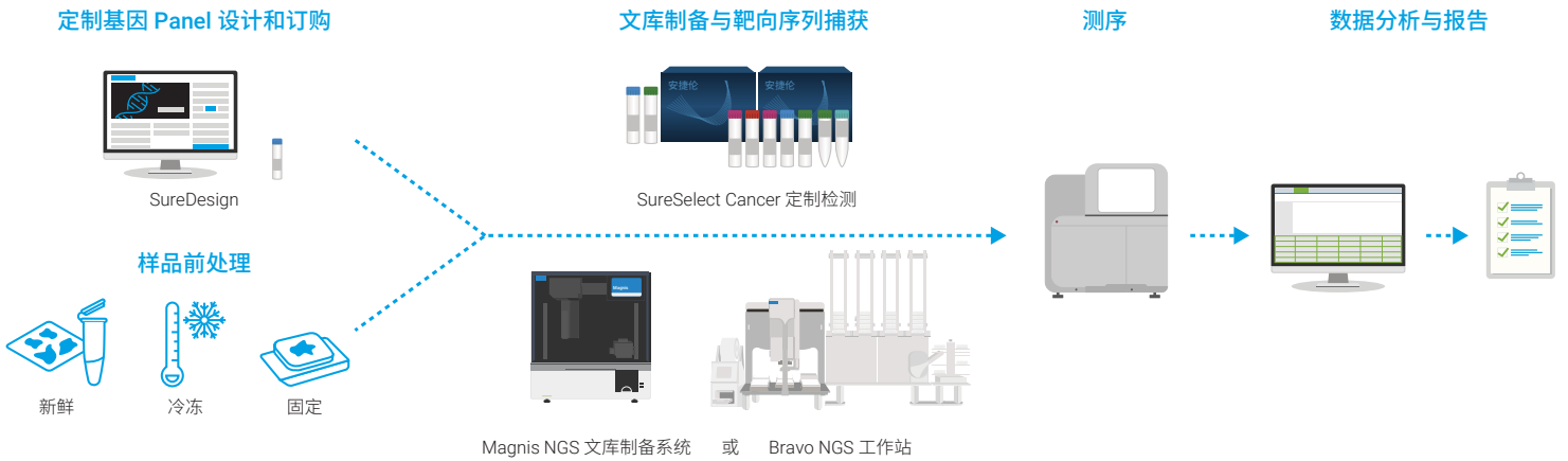
图 1. NGS 工作流程从使用 SureDesign 软件设计 SureSelect Cancer 定制基因 Panel 开始，SureDesign 软件是一种基于机器学习的探针设计门户网站。工作流程中包括使用 Agilent TapeStation 系统的样品和 NGS 文库 QC。可使用台式 Agilent Magnis NGS Prep 系统（仅需 15 分钟手动操作时间）或高通量 Agilent Bravo NGS 工作站手动/自动进行文库制备和靶向序列捕获，以生成待测序文库。在兼容的测序系统上进行测序。数据分析选项可灵活选择 Agilent Alissa Reporter 软件、客户内部软件和第三方软件，如 SOPHiA GENETICS
