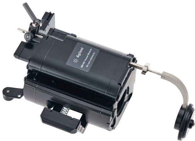
带改良延伸臂的 280-DS MQS，与各种品牌的溶出度仪兼容
