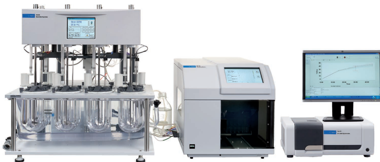
多池紫外溶出系统，包括 708-DS 溶出度仪、850-DS 溶出取样工作站和 Cary 60 紫外-可见光光谱仪
