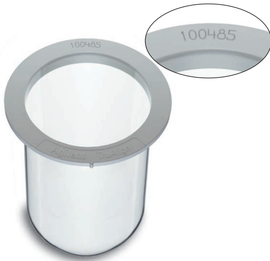
带单独序列编号的 1 L TruAlign 溶出杯（部件号 12-5149）
