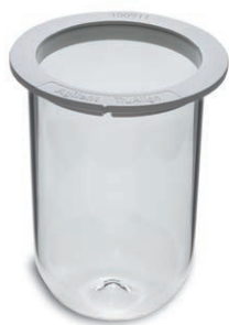
1 L TruAlign Peak 溶出杯 (部件号 12-5153)
