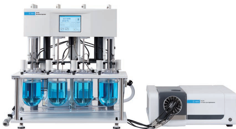
708-DS 溶出度仪和 Cary 60 光纤紫外溶出系统
