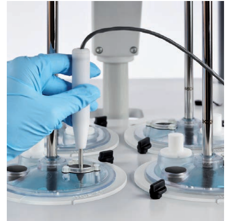
使用 708-DS 一体式手持式温度探头进行手动温度测量
