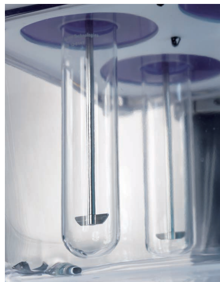
200 mL EaseAlign 转换工具包 (部件号 12-0318) 包含溶出杯适配器、微型桨和 200 mL 溶出杯, 用于小体积溶出测试
