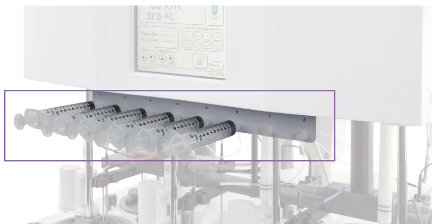
安装在 708-DS 上的手动取样支架 (部件号 17-3151 或 17-3152)
