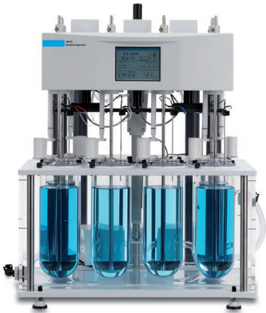
708-DS 溶出度仪：带自动升降的 8 位，2 L 型号
