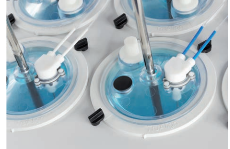
708-DS 上的驻留插管工具包。有关可用的工具包，请参见下表
