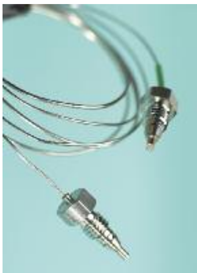
安捷伦独特的激光焊接工艺确保毛细管的端口绝对平整，消除由毛细管可能产生的死体积
