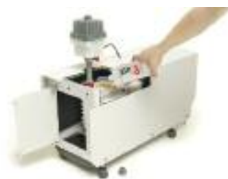
添加前级泵 (机械泵) 油, 4 升
