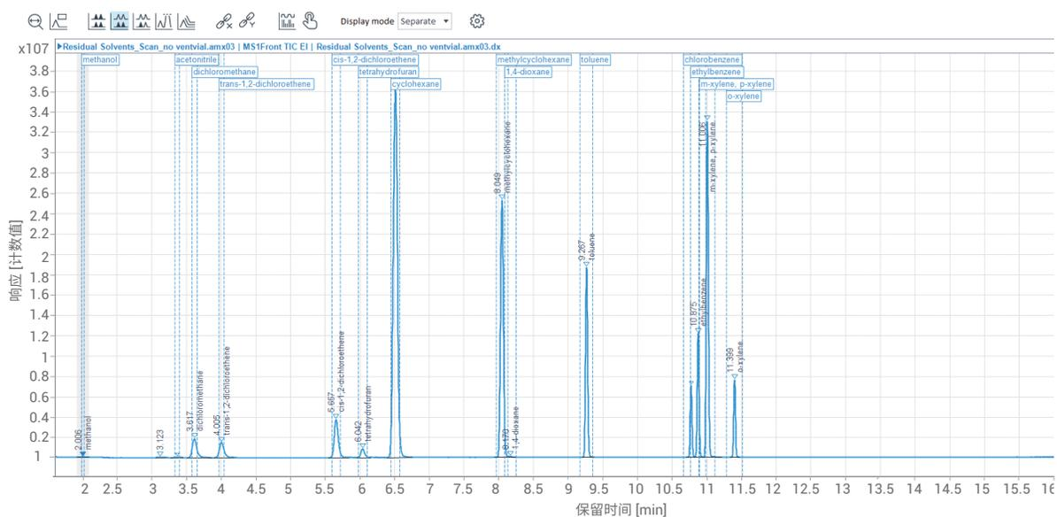
第二类残留溶剂（混标 A）的参比色谱图。使用 Agilent 7697A 顶空进样器和 5977B GC/MSD 通过 OpenLab CDS 采集溶剂数据。该软件提供了多种方式来处理和呈现 GC/MS 数据，还可确保满足 FDA 监管实验室要求的高度数据可靠性
