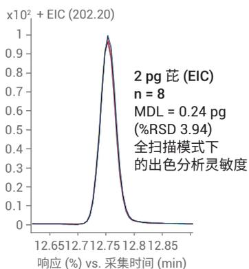
利用更高的分析灵敏度使仪器检测限 (IDL) 降低至 1.5 fg。5977B GC/MSD 使如今的单四极杆系统性能可与过去的三重四极杆系统相媲美。
