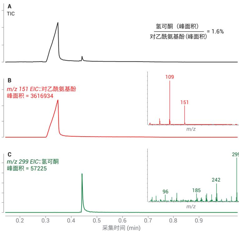
在约 1 分钟内分析粉碎维柯丁片剂 (5:300 mg 氢可酮:对乙酰氨基酚)。A) 总离子流图 (TIC)。提取离子色谱图 (EIC): 对乙酰氨基酚 m/z 151 (B), 氢可酮 m/z 299 (C)。两个组分的 NIST 谱库匹配得分均 > 90
