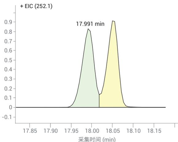
50 ppm（中点浓度）时，苯并[b]荧蒽和苯并[k]荧蒽异构体的分离度。分流比为 1:3（进样 17 ng），LPD 衬管，9 mm 直径的拉出透镜。中点浓度下，如果两个异构体峰之间的峰谷高度小于两个峰高平均值的 50%，则实现了充分分离（8270D）。
