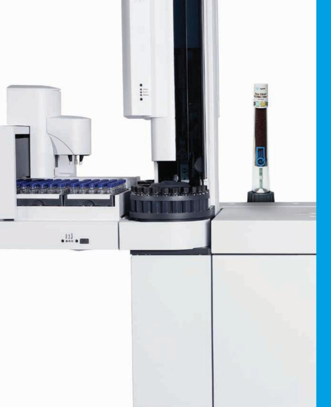
Gas Clean Filter schützen Säulen und Verbrauchsmaterialien – sie verlängern deren Lebensdauer und reduzieren den Wartungsaufwand für den GC.
