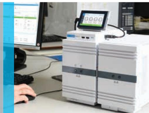
Ces technologies innovantes séparent les gaz en quelques secondes, avec un encombrement et un besoin en énergie et en gaz vecteur inférieur aux GC de paillasse. Un démarrage rapide et simple vous permet d'obtenir vos résultats en quelques minutes, même si vous modifiez fréquemment les points de mesure.
