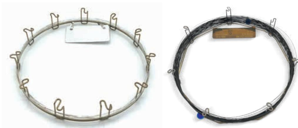
Comparación entre una columna de Agilent (derecha) y otra de la competencia (izquierda): después de funcionar a 400 °C durante 25 horas, la columna para GC 5ht del otro fabricante se descascarilló, mostrando indicios de despolimerización. El recubrimiento de la columna para GC Agilent J&W DB-5ht permaneció uniforme y la columna mantuvo su flexibilidad.
