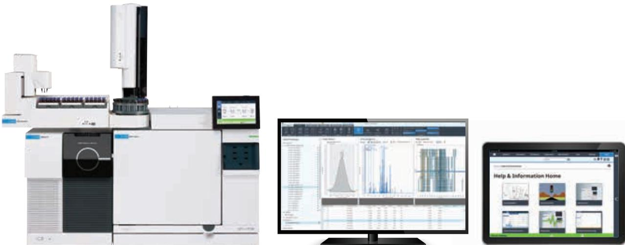
Das 8890 GC-System ist mit allen aktuellen Versionen der Agilent MassHunter und OpenLab Software kompatibel sowie mit den Hauptversionen der älteren Systeme, einschließlich OpenLab CDS ChemStation Edition, OpenLab CDS EZChrom Edition, OpenLab CDS, Multi-Technique ChemStation B.04.03SP2 und EZChrom Elite.
