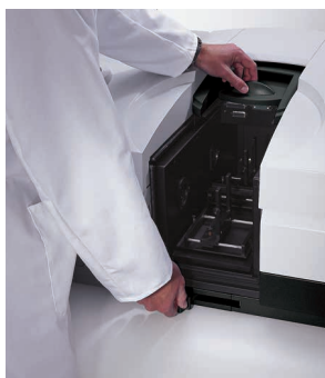
3. レバーをスライドさせてアクセサリを固定
