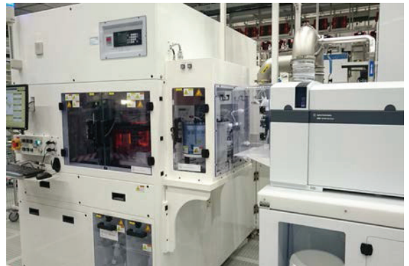
与 Agilent 8800 ICP-MS/MS 集成的由 IAS Inc. 制造的全自动 VPD-ICP-MS 系统 Expert PS。
