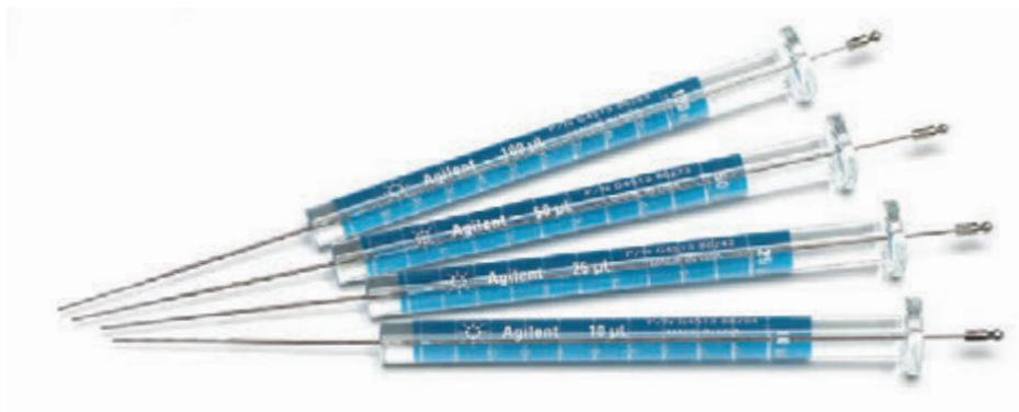
Ottieni iniezioni altamente riproducibili per un lungo periodo di tempo usando le siringhe Agilent premium Blue Line per autocampionatore per GC.
