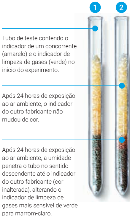
Figura 5. Os indicadores do filtro para limpeza de gases são extremamente sensíveis à umidade. Após a exposição, o indicador de limpeza de gases no tubo 2 muda de cor antes que o indicador de outro fabricante mal tenha começado a reagir.
