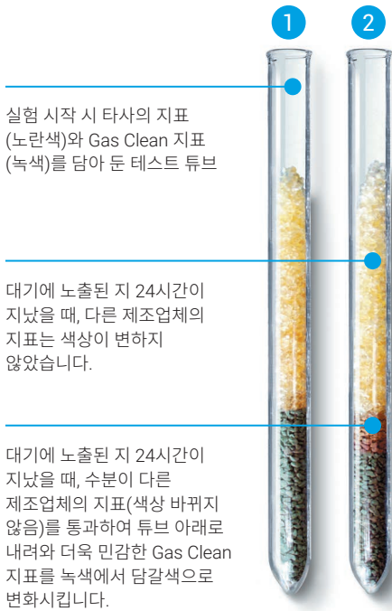
그림 5. Gas Clean 필터 지표는 수분에 매우 민감합니다. 노출 후, 튜브 2의 Gas Clean 지표는 다른 제조업체의 지표들이 반응을 거의 보이지 않는 데도 색상이 변합니다.
