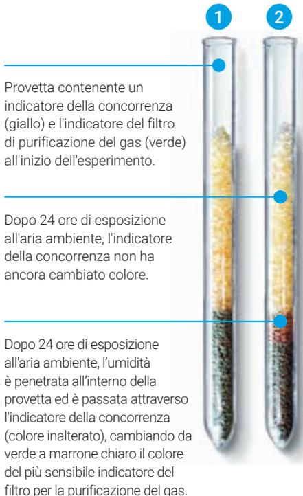
Provetta contenente un indicatore della concorrenza (giallo) e l'indicatore del filtro di purificazione del gas (verde) all'inizio dell'esperimento.
