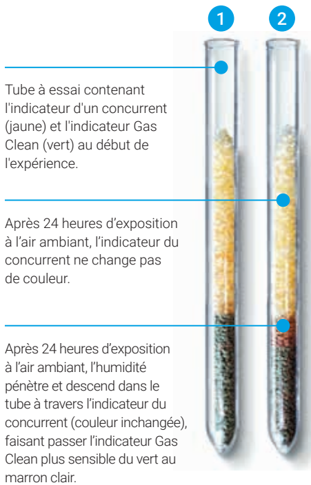
Figure 5. Les indicateurs de filtre Gas Clean sont extrêmement sensibles à l'humidité. Après exposition, l'indicateur Gas Clean du tube 2 change de couleur alors que l'indicateur du concurrent a à peine commencé à réagir.
