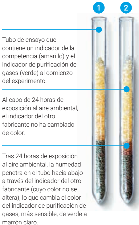
Figura 5. Los indicadores del filtro de purificación de gases son extremadamente sensibles a la humedad. Después de la exposición, el indicador de purificación de gases del tubo 2 cambia de color antes de que el indicador del otro fabricante apenas haya comenzado a reaccionar.
