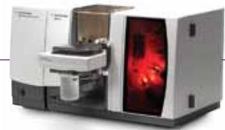
**Agilent 240FS/280FS AA** 配上 GTA 120 石墨炉，用于测定极低检测限量 (低 ppb 或 ppt) 的元素。该系统尤其适用于仅需分析少量元素或样品量极少的情况。
