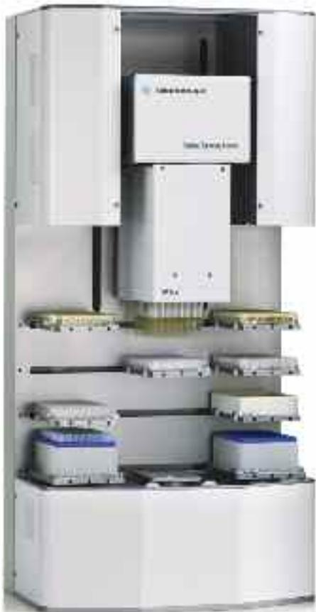
竖式移液器的 8 个滑动托架安装在移液头的两侧，使其在节省台面空间的同时还能够访问所有微孔板
