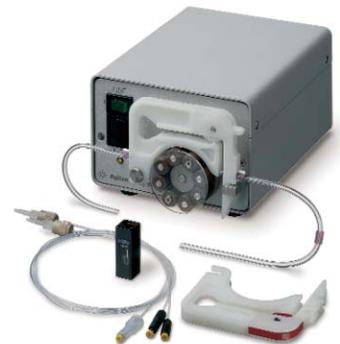
蠕動泵系統可以提高液體樣品重複測定時的工作效率，並消除手工操作帶來的誤差。安捷倫蠕動泵系統包括蠕動泵和一個石英流動池：
