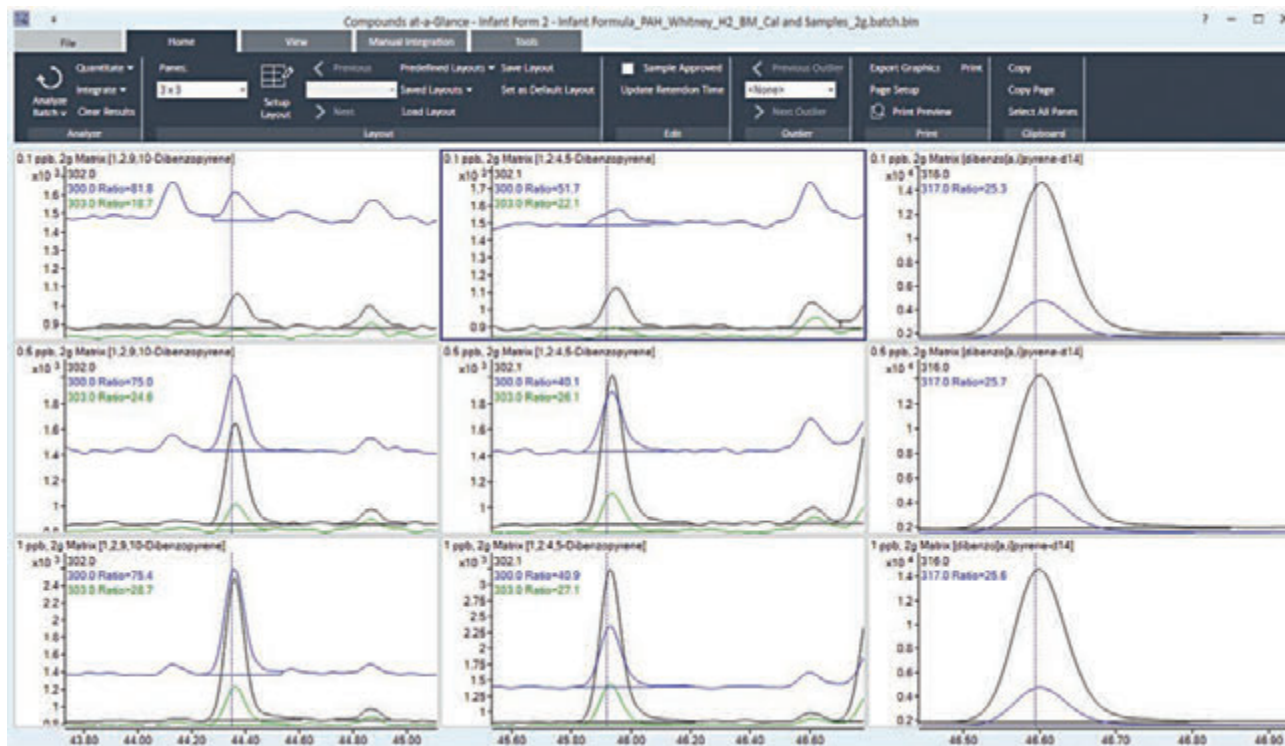
Affichage Compounds-at-a-Glance hautement personnalisable pour le 1,2,9,10-dibenzopyrène, le 1,2,4,5-dibenzopyrène et le dibenzo[a,i]pyrène-d14 aux niveaux d'étalonnage 0,1, 0,5 et 1 ppb.
