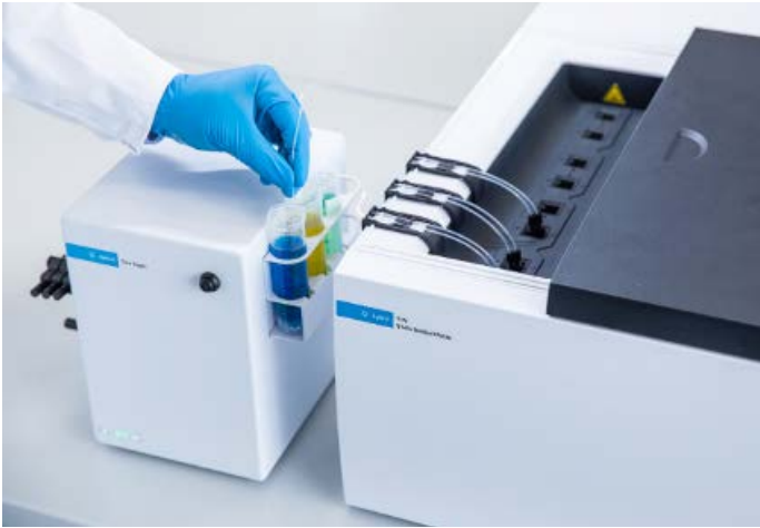
그림 1. Cary 3500 Multicell UV-Vis 분광 광도계에 연결된 Cary Sipper 액세서리.
