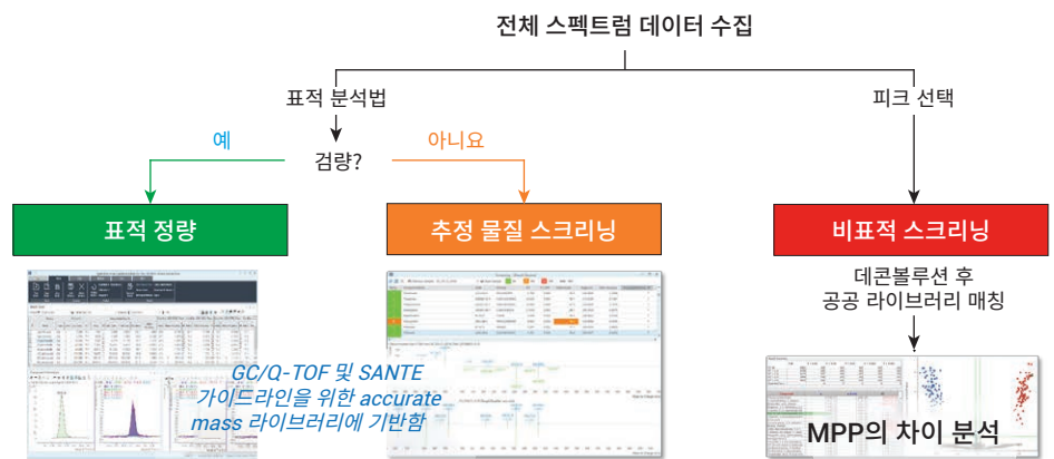
그림 2. GC/Q-TOF PCDL을 사용한 표적 및 추정 물질 스크리닝 접근법과 NIST 라이브러리를 사용한 비표적 스크리닝에 기반한 결합된 오염물질 스크리닝 워크플로를 모두 Agilent MassHunter Quantitative Analysis 10.1 소프트웨어 내에서 수행했습니다.
