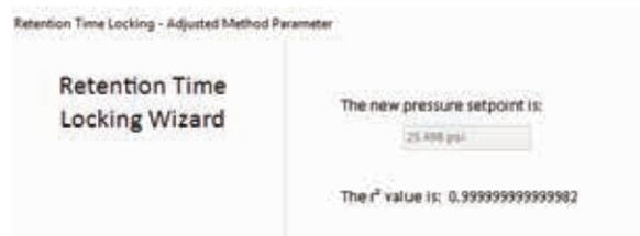
Figura 7. Resultados da calibração da pressão de travamento do tempo de retenção.
