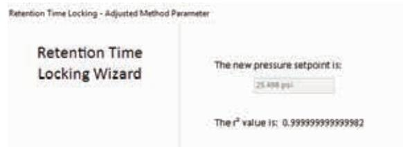
Figure 7. Résultats de l'étalonnage de la pression pour le calage des temps de rétention.
